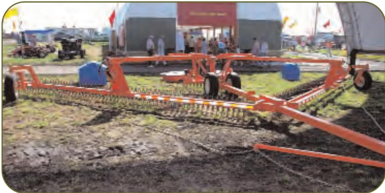
THE PHOENIX® HARROW IS A HIGH RESIDUE TILLAGE TOOL THAT DISTURBS THE SOIL .5 TO 2 INCHES DEEP, LEAVING MOST OF THE RESIDUE ON THE SOIL SURFACE. THE GREATER THE HARROW IS ANGLED OFF THE TOOL BAR, THE MORE THE OPERATION WILL DISTURB THE SOIL.
