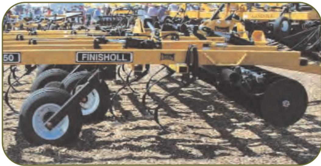
**THE SELECTION OF THE SPECIFIC PRIMARY TILLAGE TOOL AND TYPE OF POINTS OR BLADES IS IMPORTANT TO THE SUCCESS OF MULCH-TILL SYSTEMS. GENERALLY, THE LESS INVERSION ACTION THE POINT OR SHOVEL CREATES, THE LESS RESIDUE IS BURIED.**
