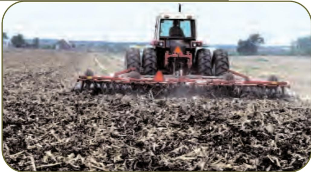
THE TANDEM LIGHT FINISH TOOL PROVIDES LESS SOIL DISTURBANCE THAN THE OFFSET DISK, LEAVING MORE RESIDUE ON THE SOIL SURFACE. THE AMOUNT OF RESIDUE LEFT ON THE SOIL SURFACE DEPENDS UPON THE DEPTH OF TILLAGE, SPEED AND MOISTURE CONTENT OF THE SOIL AT THE TIME OF TILLAGE.
